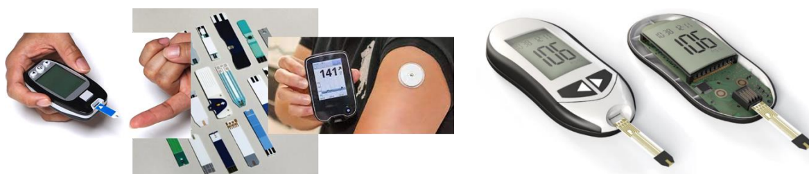
شکل ۱: انواع نوار اندازه‌گیری قند خون و سیستم پیشرفته اندازه‌گیری قند خون پیوسته پوشیدنی که بر اساس جوهرهای رسانای کربنی و نقره ساخته می‌شوند.
